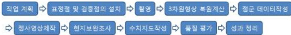
그림 12 UAV에 의한 3D지형구축 FLOW
