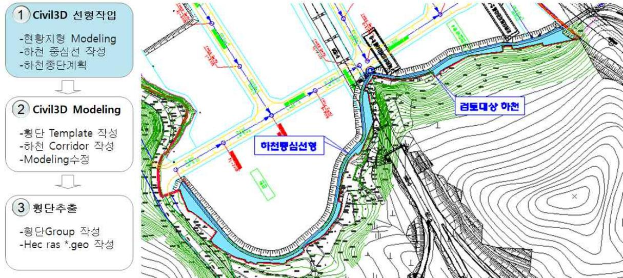
그림 39 BIM기반 하천 선형 작성
