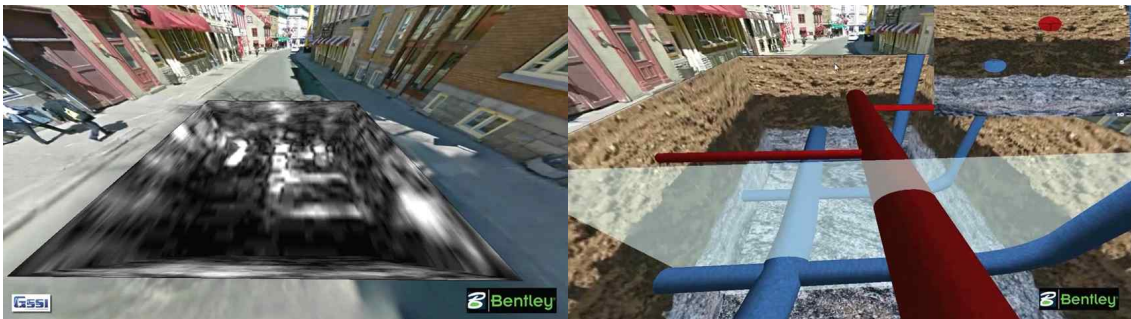
파노라마 사진과 GPR(좌) 또는 BIM(우)의 중첩을 통한 지하시설물 가시화
